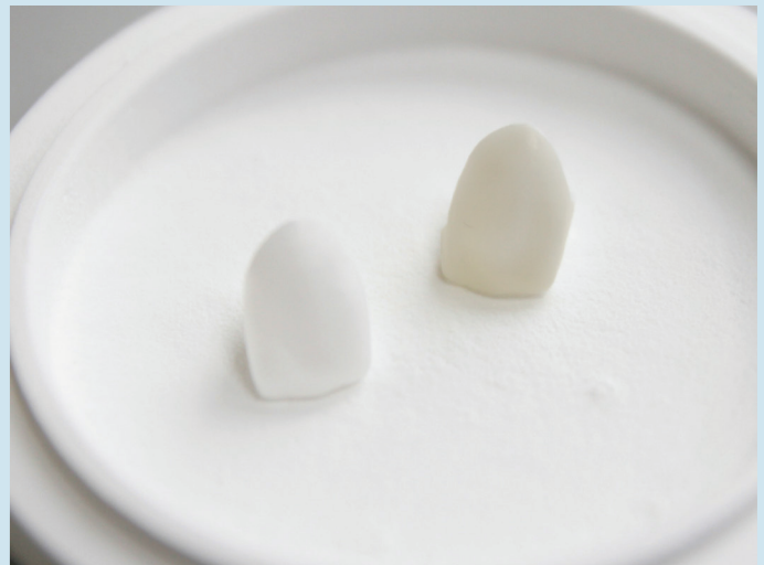
Рис. 1. Наглядный пример загрязнения неокрашенного оксида циркония. Слева коронка спеченная в чистой печи, справа - в печи с загрязненной камерой спекания. Разница отчетливо видна.
